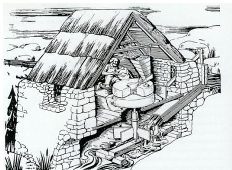
Abbildung 3: Wassermühle. (Quelle: Streifzüge Technik, o.J.)
